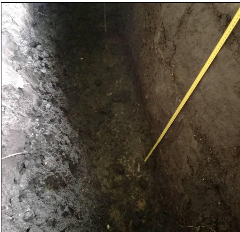
Obr. č. 7 - pohled na dno kopané sondy - zabetonovaný otvor přilehlého propustku
